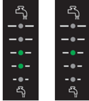
Gbr. 14 Indikasi tekanan pelepasan SCALA2
