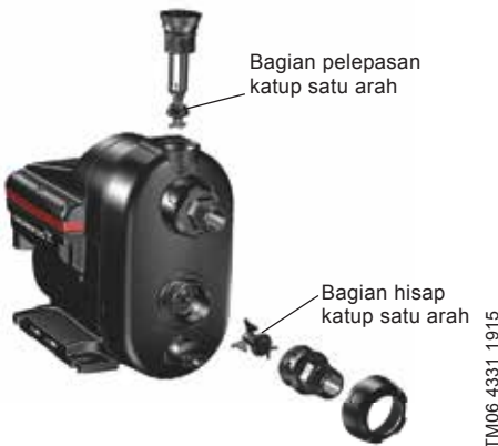
Gbr. 20 Bagian hisap dan pelepasan katup satu arah
