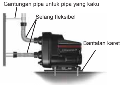
Gbr. 4 Cara mengurangi bising dalam pemasangan
